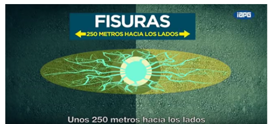
Gráfico 8. Radio de fisura.
