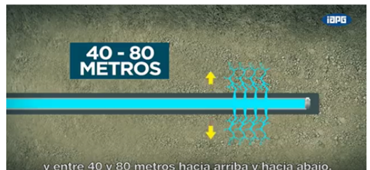
Gráfico 9. Radio de fisura.
