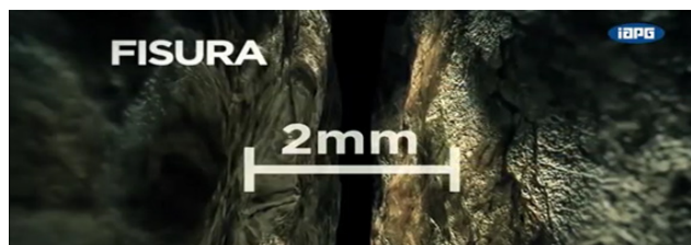
Gráfico 10. Dimensión de las fisuras provocados por el líquido de fractura.
