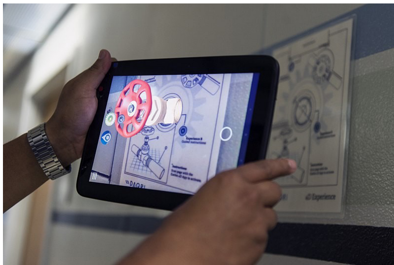
Figura 4.1: Manual técnico enriquecido con RA, gracias al cual un marinerero puede ver un modelo 3D de una válvula.
