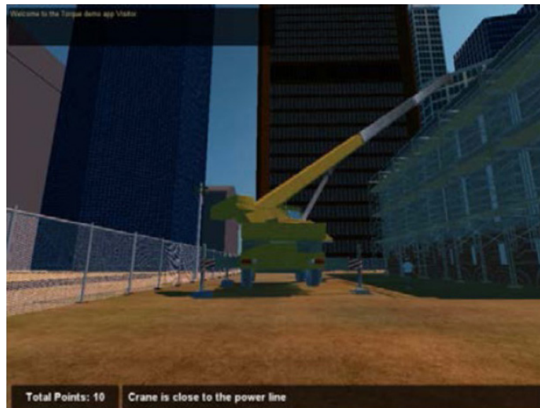
Figura 4.2: Safety Inspector: El jugador ganó 10 puntos al identificar correctamente un peligro asociado a la grúa móvil, que se encuentra demasiado cerca de una línea eléctrica aérea (Lin et al., 2011).
