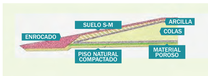
■ Figura 4: Esquema de encapsulado de colas de mineral.
