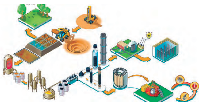
■ Figura 3: Esquema del Ciclo de Combustible Nuclear que se realiza en Argentina. ©CNEA
