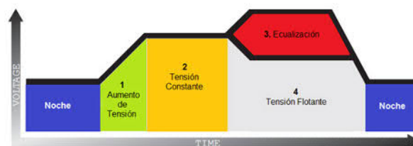
Figura N/6: Curva de carga de baterías de ciclo profundo. Fuente: http://www.morningstarcorp.com/wp-content/uploads/2014/02/150V-TS-MPPT-Operators-Manual.pdf
